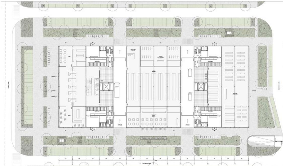
**Abbildung 7:** Grundriss Erdgeschoss – Innere Ladezone im Testentwurf, Grundstück 1: Das Gebäude nutzt die Freiheiten durch die interne Durchfahrt in seiner allseitigen Freiraum- und Fassadengestaltung. Die Lärmentwicklung findet kontrolliert im Gebäudeinneren statt (maßstabslos).
